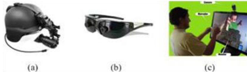
Figura 5. Tecnología empleada en Realidad Aumentada. En (a) se muestra un modelo de sistema de seguimiento HMD ( Head Mounted Display ); en (b) un modelo de gafas de visión aumentada; en (c) se advierte un PC con cámara web y marcadores posicionales. (Fuente, Zlatanova, 2002)
